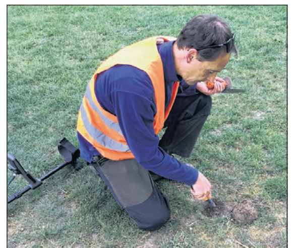
Gibt der Detektor einen Metallgegenstand an, wird er exakt geortet und vorsichtig mit einem Grabmesser geborgen.
